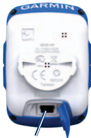
Port mini-USB sous le cache étanche
