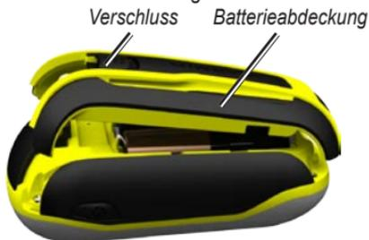
2. Legen Sie die Batterie ein. Richten Sie die Plus- und Minuskennzeichnungen (+ bzw. -) auf dem Gerät mit denen auf der Batterie aus.
